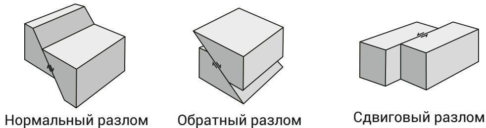
Рисунок 1.1 Три основных типа разломов
